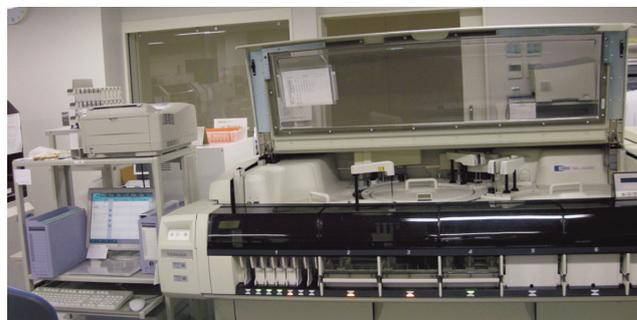
写真は生化学・免疫分析装置（TBAc16000・ARCHITECT i2000SR 連結タイプ）で、検体処理能力は1時間に約2000項目の測定が可能です。
