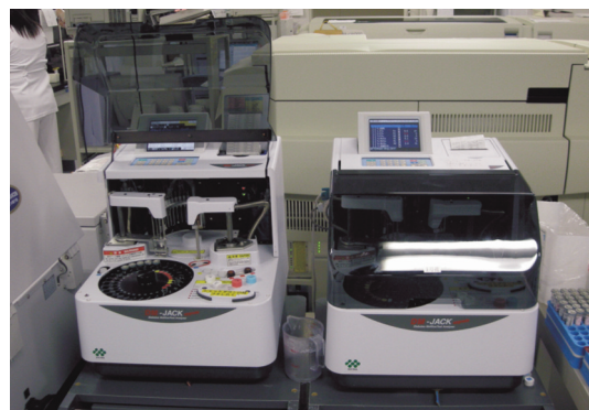
血糖、ヘモグロビンA1Cを測定する装置で1時間に約180テスト測定することができます。
